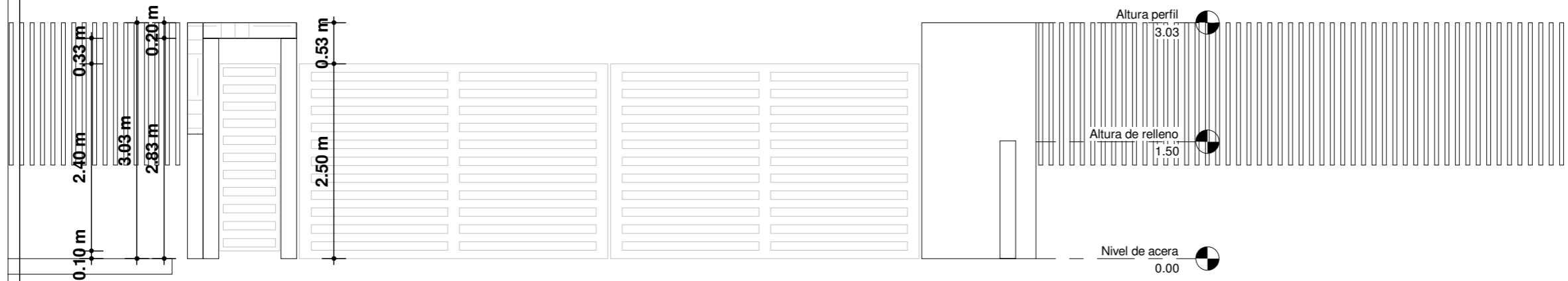
2 Elevacion frontal - Detalle Porton A103 1 : 75
